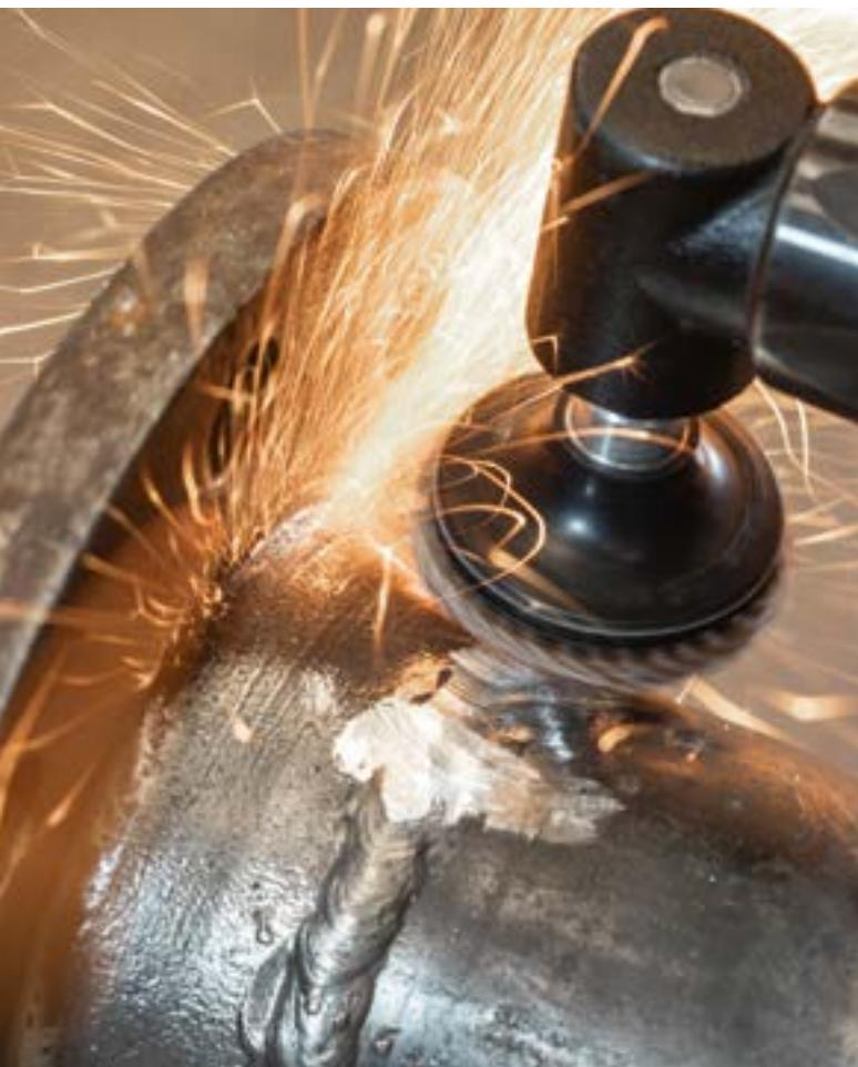
Geeignet für großflächige Arbeiten sind Schleifscheiben oder Bürsten. Starten Sie nach dem Auskühlen mit dem Entgraten bzw. Abtragsschleifen, auf das dann der Feinschliff und das Finish erfolgen.
