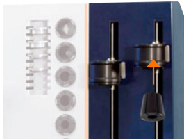
Abb 11: Einsetzen des Kühleinsatzes in einem freien Kontaktkühler.
