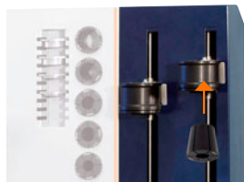
Fig. 11: Placement de l'insert de refroidissement dans un refroidisseur à contact libre.
