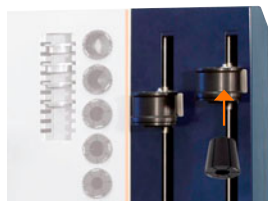
Рис. 11: Установка охлаждающей втулки в свободную водо-охлаждаемую гильзу
